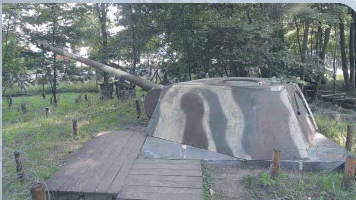
Niemiecki punkt oporu typu Pantherturm – diorama Fort Gerharda Świnoujście sierpień 2013 fot. autora
